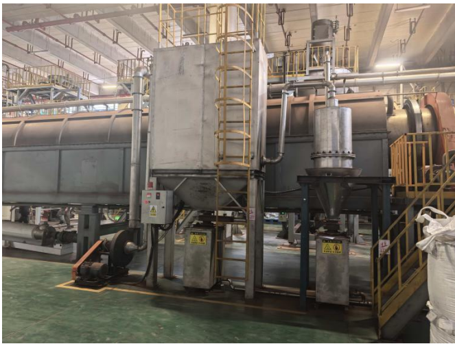
生产-包装废气收集及滤筒除尘
