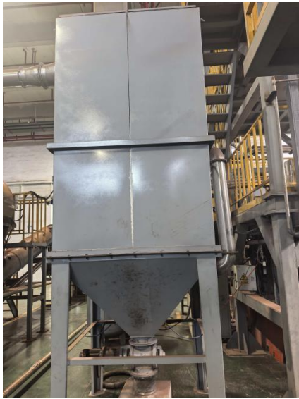
生产-破碎废气收集及滤筒除尘
