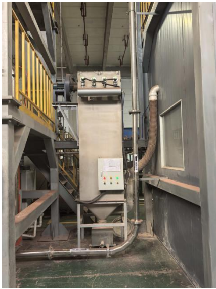
生产-破碎废气收集及滤筒除尘
