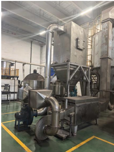
生产-破碎废气收集及滤筒除尘
