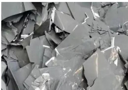
废旧磷酸铁锂正极片
