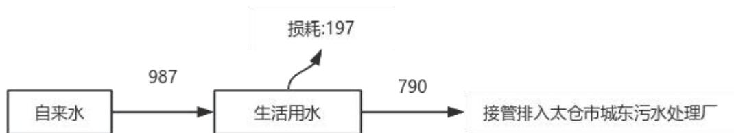
图 4-3 本项目水平衡图 (t/a)
