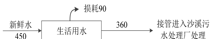
图 5-2 本项目水平衡图 单位：t/a
