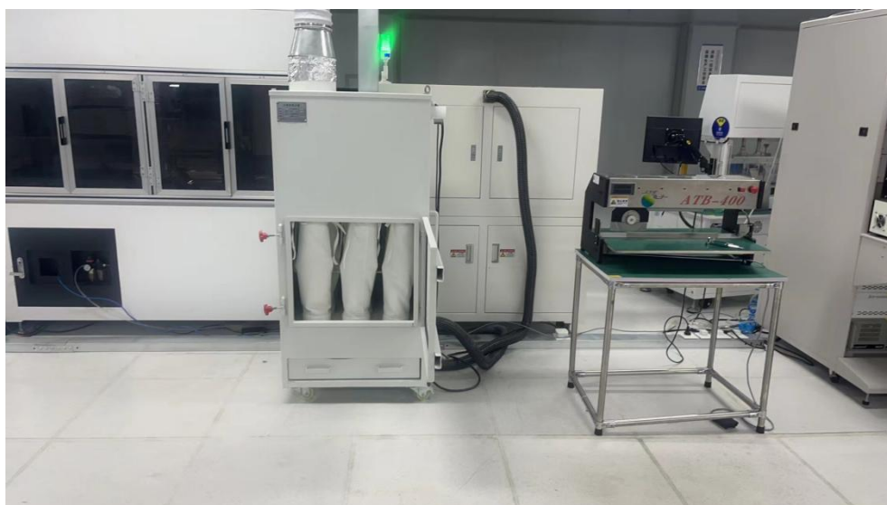
图 4-2 分板设备自带除尘器
