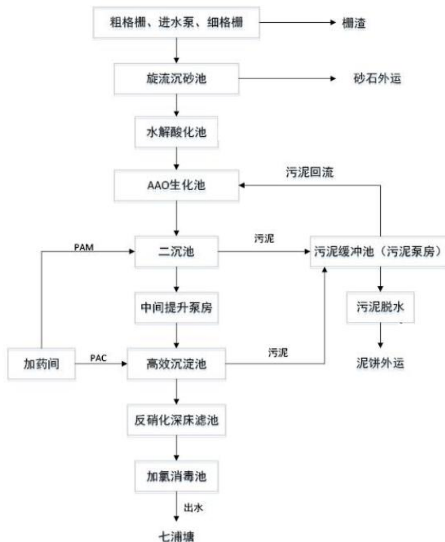
附图 4-6 沙溪污水处理厂污水处理工艺
