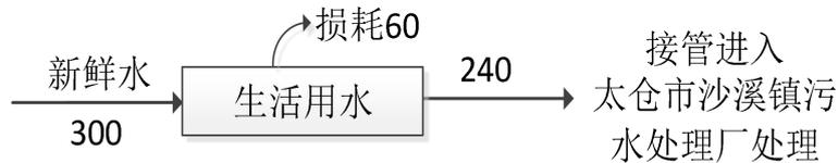
图 5-2 本项目水平衡图 单位：t/a
