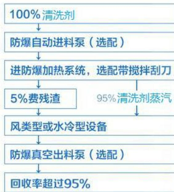
图 1-2 清洗剂回收流程图
