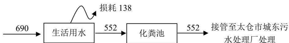
图 2-1 全厂用排水平衡图 (t/a)
