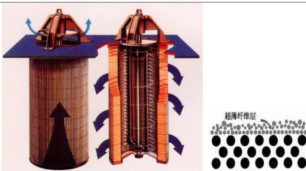
图 7-4 粉末喷房及粉末回收系统工作示意图
