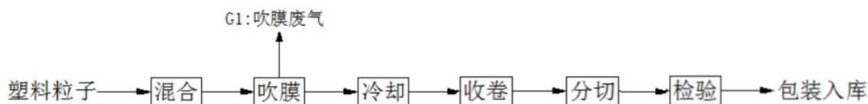
图 3-3 生产工艺流程及产污节点图
