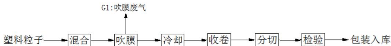
图 3-3 高密度聚乙烯防粘膜原膜生产项目生产工艺流程及产污环节图
