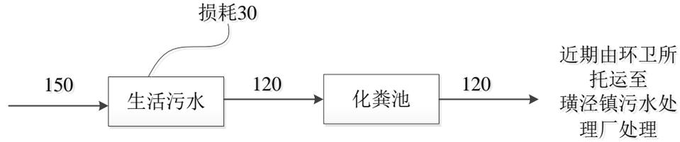
图 5-2 本项目水平衡图 (t/a)
