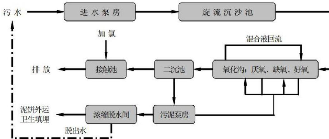
图7-1 浏河镇污水处理厂处理工艺流程图
