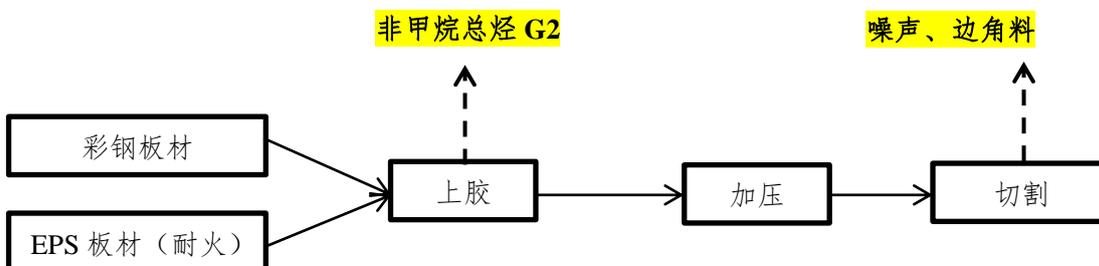
图 5-2 运营期彩钢夹芯板生产工艺流程图
