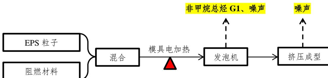
图 5-1 运营期 EPS 板材生产工艺流程图
