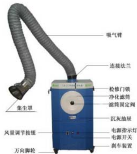
图 4-1 移动式焊烟净化器设备结构图
