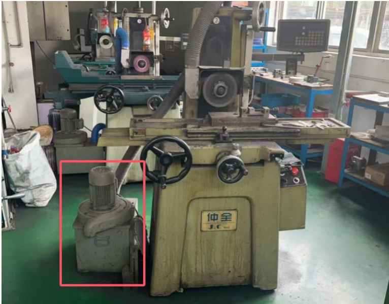
磨床设备配套的除尘系统
