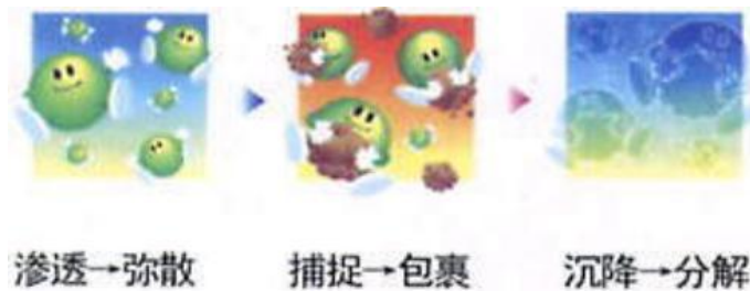
图 4-1 植物液喷淋除臭原理示意图
