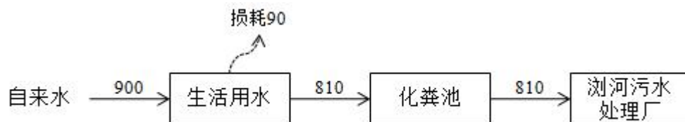
图 2 建设项目全厂用排水平衡图 (单位 t/a)
