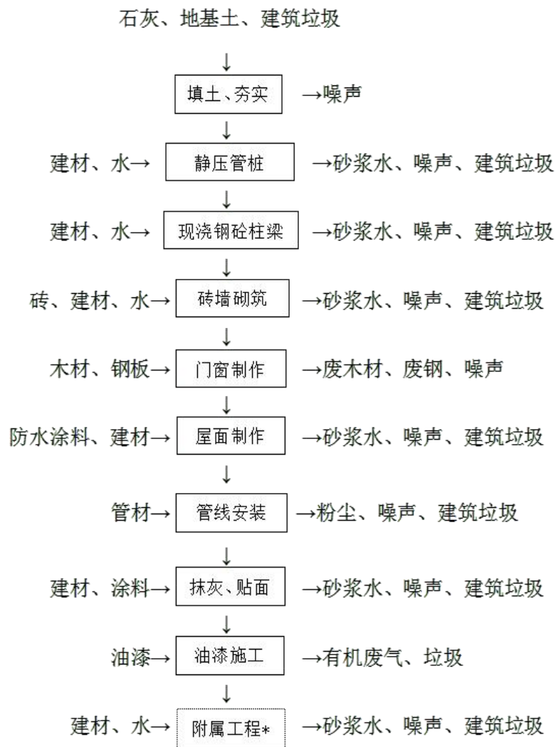
图 2-2 施工期工艺流程及产污环节图
