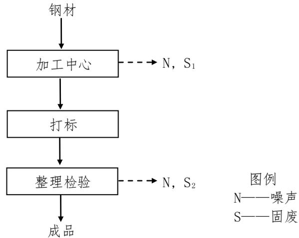
图 1 建设项目生产工艺流程图
