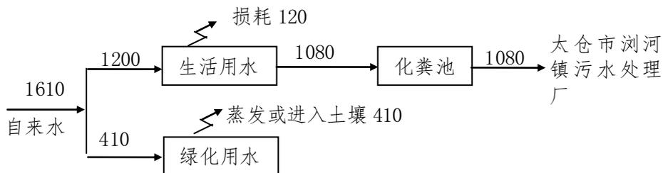
图 2 建设项目用排水平衡图 (单位 t/a)
