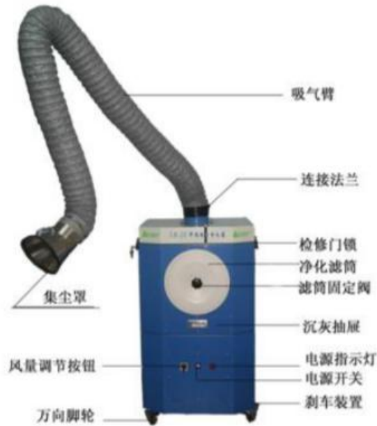
图 7-1 移动式焊烟净化器设备结构图
