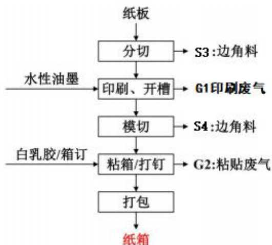
图 2-2 纸箱工艺流程及产污环节图
